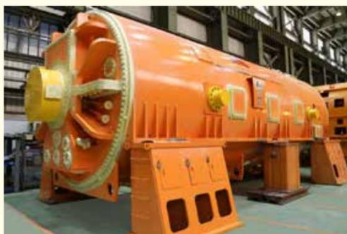
مزاياء استخدام الهيدروجين في توربينات الكهرباء إن استخدام الهيدروجين في توربينات الجيل الجديد له عدة مزايا، وهي: كفاءة عالية: تقلل من خسائر الطاقة بنسبة ٣٠-٤٠٪ مقارنة بالتبريد الهوائي.
