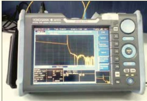
من أهم الأجهزة في عملية إنشاء البنية التحتية وكذلك صيانة واستكشاف أخطاء شبكات الألياف الضوئية وإصلاحها. وأردف: عبر تقنية الليزر والإشارات الضوئية، من الممكن لهذا الجهاز قياس معاملات الانعكاس والتوهين
