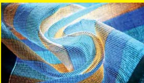
مثل نقرة الإصبع من تغيير نمط المجالات المغناطيسية على الإطار، وبالتالي إنشاء تيار كهربائي عبر الخيط. الجهاز شديد الحساسية للإجهاد الميكانيكي الحيوي ويحول نشاط العضلات إلى إشارات كهربائية عالية الدقة قابلة للقياس يتم
